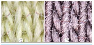
Fig. 4. Microscopic structure of coolmax (c) and cotton (d) fabric
